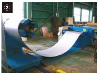
工程② ▶ レベラーにて切断。
