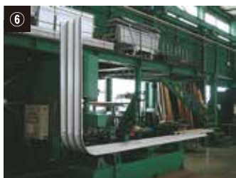
工程⑥ ▶ 片側曲げ完了。
