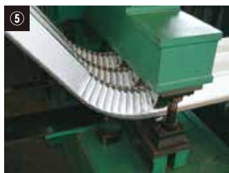
工程⑤ ▶ R曲げ機にて曲げ加工の開始です。
