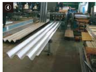
工程④ ▶ ルーフデッキ88の完成です。
