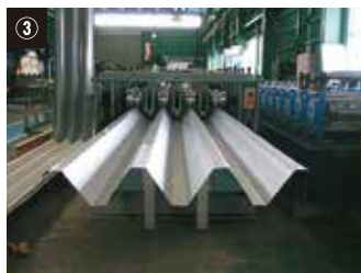
工程③ ▶ ルーフデッキ成型機に通します。
